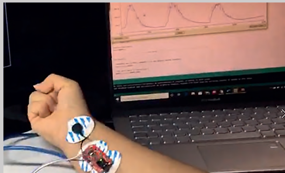
Contracción y relajación de los músculos del antebrazo para la captación de la señal mioeléctrica
